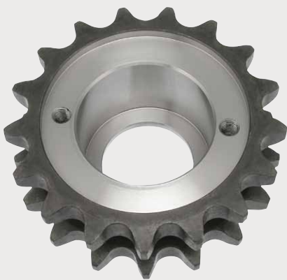
Kettenrad mit induktivgehärteten Zahnkränzen, Sondernabe und Gewindebohrungen
