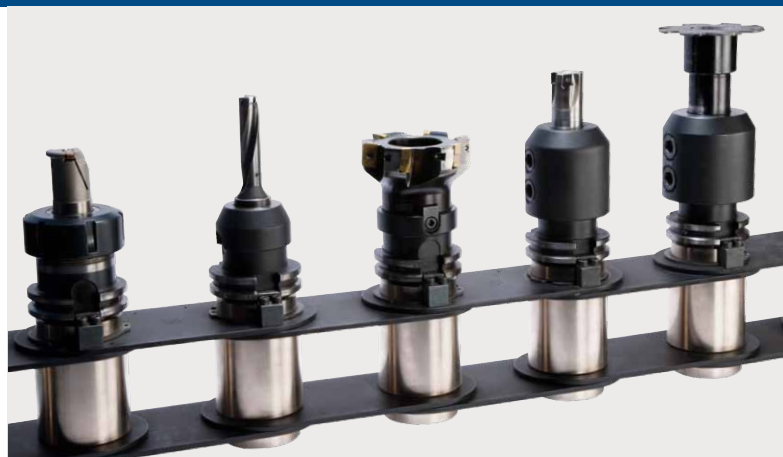
Werkzeug-Magazinkette 320 mit vernickelten Töpfen zur Werkzeug-Aufnahme
