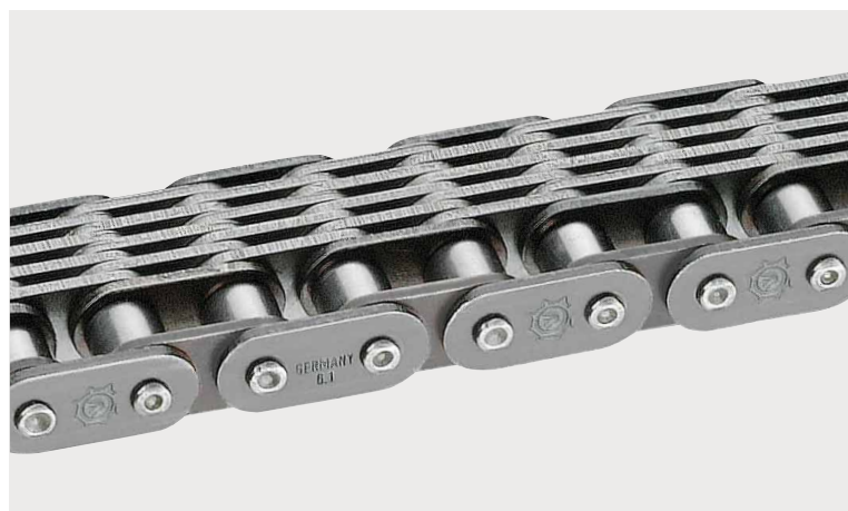
Sonderkette als Kombination aus Flyerkette (Auflage) und Rollenkette (Antrieb)
