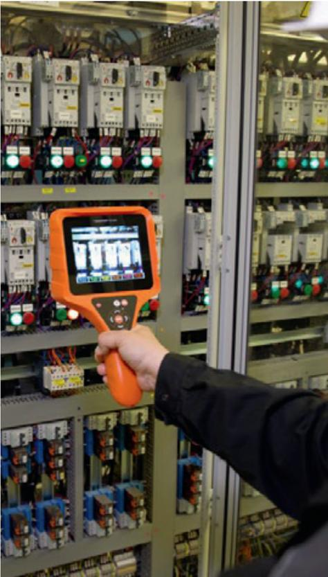
Der neue T°SHOOTER® TS1000 erfasst schnell und präzise die verschiedenen Temperaturzonen und zeigt diese direkt auf dem Kamera-Display an.
