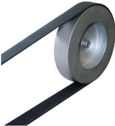
Der Antrieb von glatten Riemenscheiben mittels der Rippen eines **Poly V**-Antriebsriemens ist möglich. Da jedoch die Kontaktfläche einer glatten Riemenscheibe kleiner ist als die einer Keilrippen-Riemenscheibe, muss dies bei der Konzipierung des Antriebs entsprechend berücksichtigt werden.
