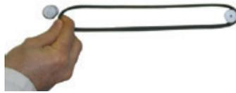
Das Spannen der Flexonic®-Antriebsriemen ist vereinfacht: es erfordert keinerlei Schritt zum Ausbau der Riemenscheibe.
