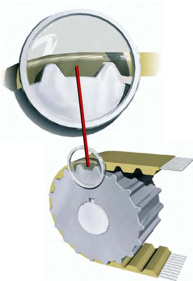
Die Produktionsverfahren, nach denen CONTI® SYNCHROFLEX Polyurethan-Zahnriemen hergestellt werden, ermöglichen enge Toleranzen, die eine gleichmäßige Verteilung der Last bei der Leistungsübertragung gewährleisten. CONTI® SYNCHROFLEX Polyurethan-Zahnriemen eignen sich zur Übertragung hoher Drehmomente ebenso wie für das genaue Positionieren und Transportieren der verschiedensten Güter.
