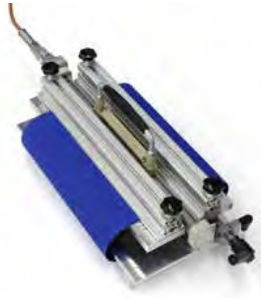
Kompakt und mobil: die praktische Schweißvorrichtung HS für Förderbänder
