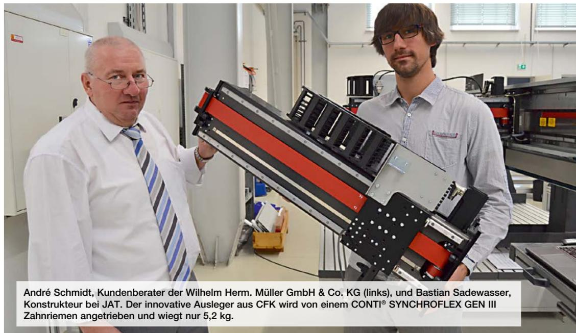
André Schmidt, Kundenberater der Wilhelm Herm. Müller GmbH & Co. KG (links), und Bastian Sadewasser, Konstrukteur bei JAT. Der innovative Ausleger aus CFK wird von einem CONTI® SYNCHROFLEX GEN III Zahnriemen angetrieben und wiegt nur 5,2 kg.
