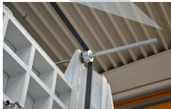
Clever gelöst: Ein verschweißter BRECO® AT10-Zahnriemen treibt in der riesigen Zusammenbau- und Gasfüllpresse vier Spindeltriebe synchron an.
