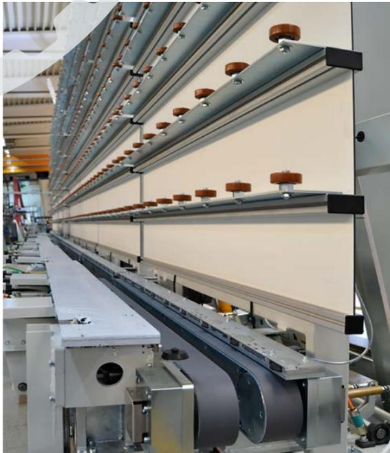
Aneinandergereihte Zahnriementriebe mit dem beschichteten BRECOFLEX® AT15 für den Transport und die genaue Positionierung während der CNC-Bearbeitung.
