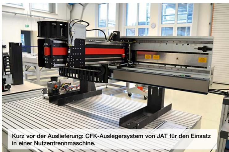
Kurz vor der Auslieferung: CFK-Auslegersystem von JAT für den Einsatz in einer Nutzentrennmaschine.
