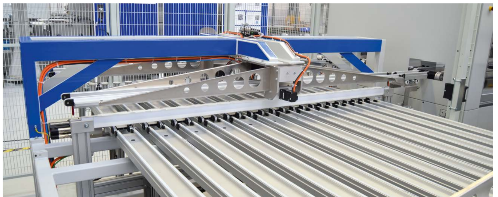
Der Querbalken übernimmt die Strings von der Stringermaschine (rechts oben).
