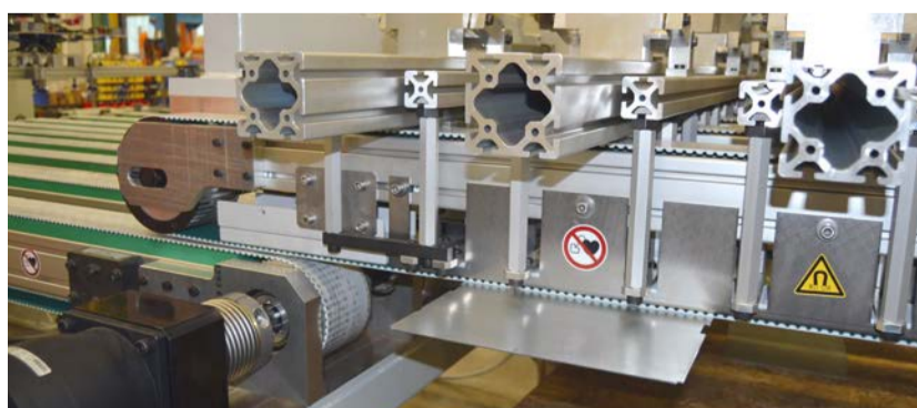
Übergabestelle: Die Platinen werden vom liegenden Band auf das hängende Band übergeben. Dauermagnete halten es sicher am Zahnriemenrücken.
