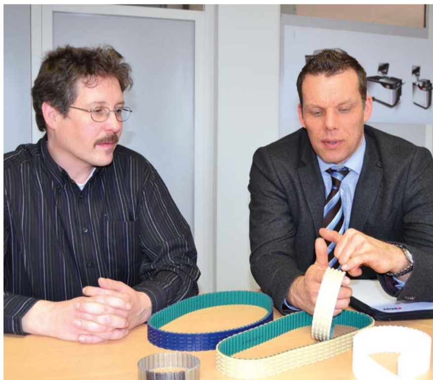
Alle Zahnriemen für die Schneidmaschinen auf einen Blick: Der weiße ist doppelt verzahnt und dient als Hauptantrieb. Der kleine silberne koppelt die Riementreiber der zwei beschichteten Zahnriemen. Volker Helle (links) und Rainer Müller kennen alle Details dieser ausgeklügelten Zahnriemen.
