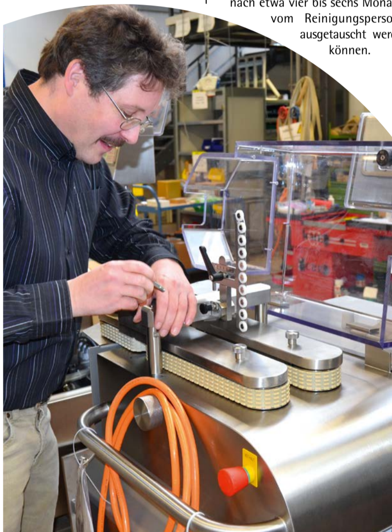
Inotec-Einkaufs- und Fertigungsleiter Volker Helle demonstriert den einfachen Zahnriementausch ohne Werkzeug.
