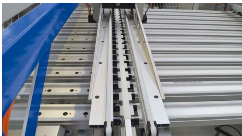
Unter dem Querbalken ist der Hebestempel positioniert, der die Strings vom Balken abhebt und auf die unten liegenden Transportriemen ablegt.
