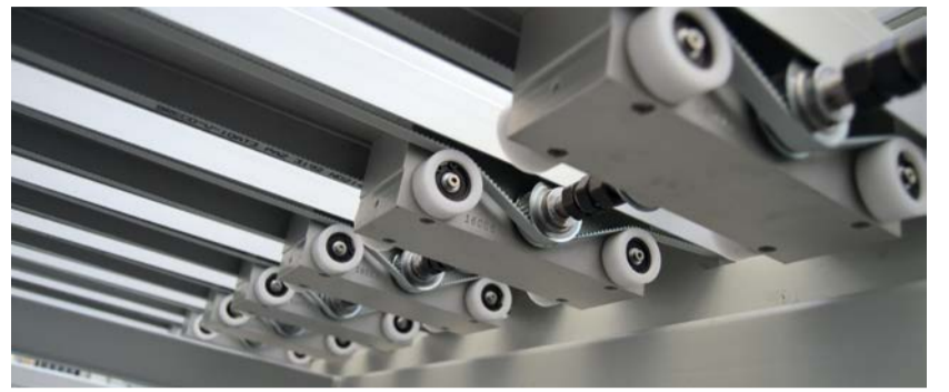
Der Antrieb wurde aus Platzgründen nach unten verlegt.
